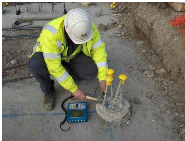
Рисунок 1 – Тестирование буронабивной сваи на строительной площадке
